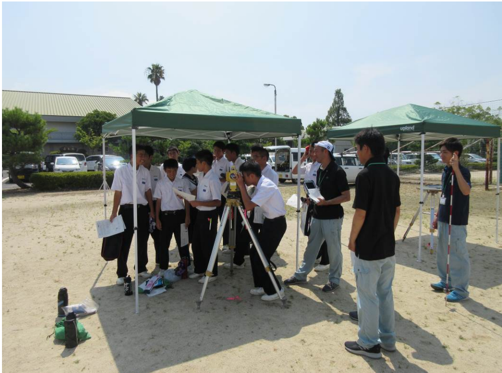
最新：トータルステーションによる方向位置、光波距離測定、 タフパットによる図面作図)
