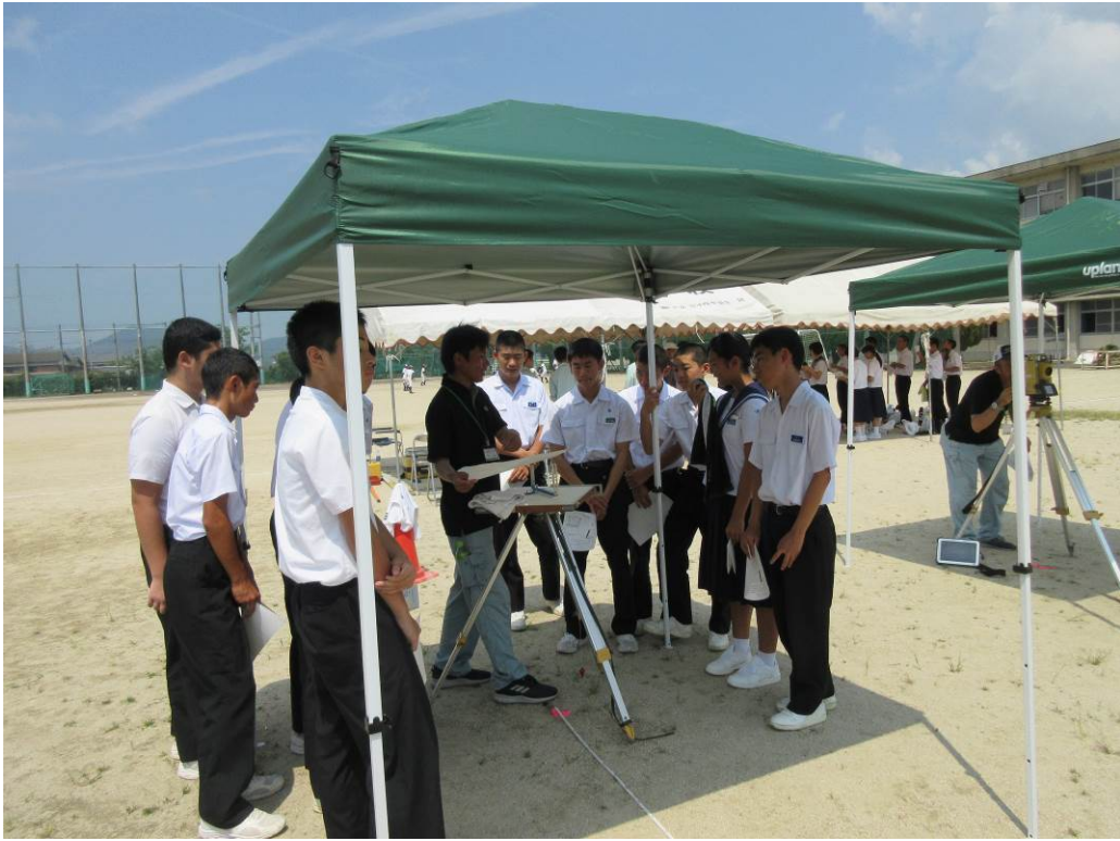
昔の平板測量（アリダード（方向視準）とテープ距離測定による図面作図）
