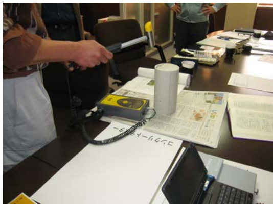
(写真↑ 住宅診断でコンクリート強度調査に使用するコンクリートテスター(C TS-02)の説明状況:説明者は当社長崎テクニカルリーダー)
