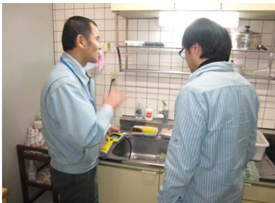
(写真↑ 住宅診断でコンクリート強度調査に使用するコンクリートテスター(C TS-02)の説明状況:説明者は当社長崎テクニカルリーダー)
